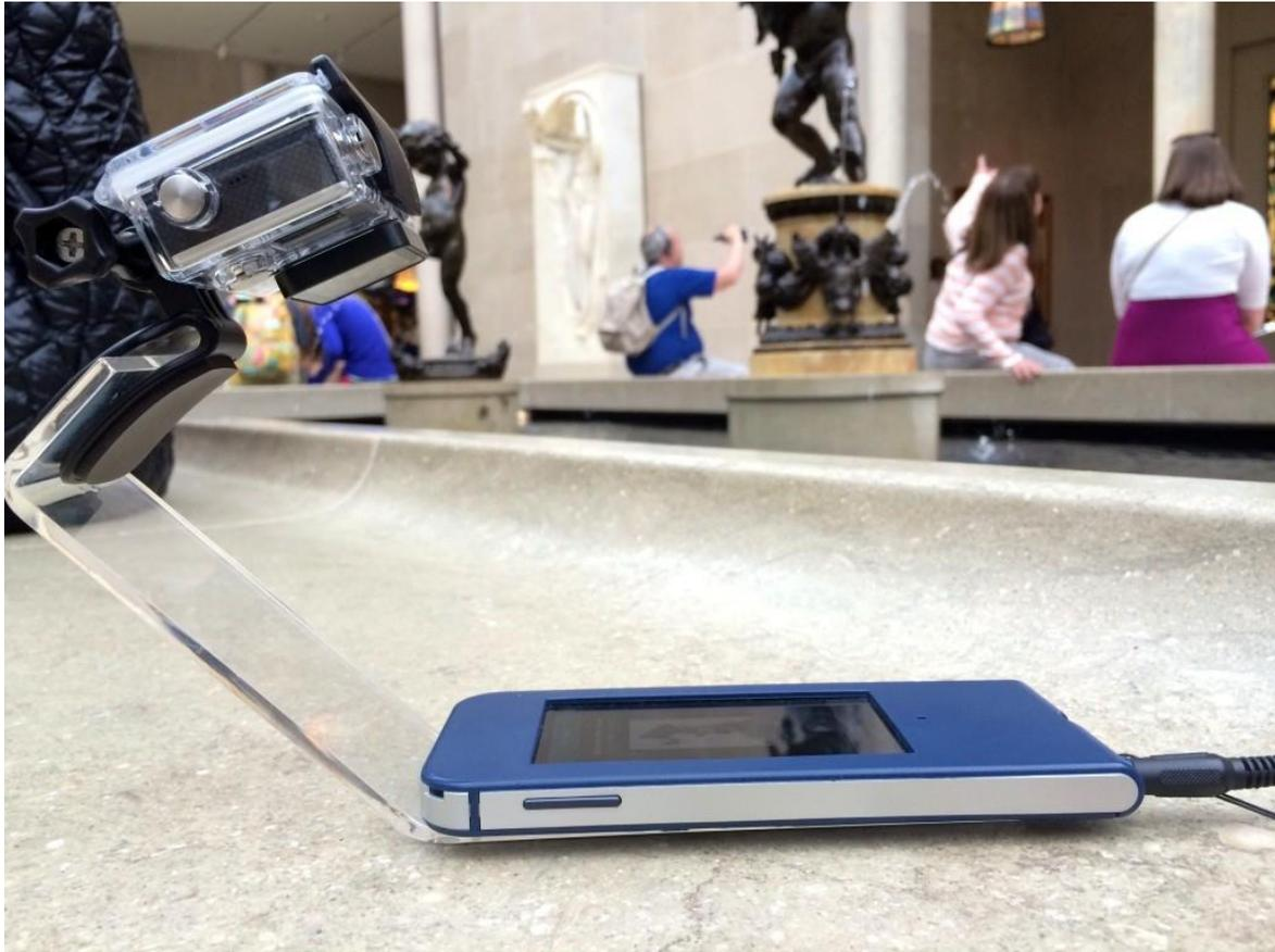
Figura 3: equipo de prueba de usabilidad en la galería Videocámara GoPro® y reproductor de audioguía montados en una base de acrílico.
